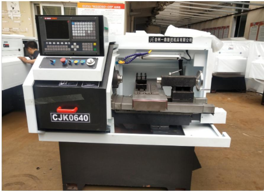
线轨数控机床在可靠性与密度稳定性方面还存在较大差距。线轨数控机床在近年的发展浪潮中，不断进步与完善，已逐步跟上机床技术强国的步伐。目前，线轨数控机床等功能方面更加完善，在机床外观结构更为宜人，在质量性能方面更为可靠。总体表现出一种新趋势，那就是线轨数控机床将更为市场所青睐。线轨数控机床操作中要知道的注意事项：操作者须熟悉机床的结构，性能及传动系统，润滑部位，电气等基本知识和使用维护方法。经常注意机床的润滑情况，须按润滑表规定进行润滑工作，须保持油标线的高度符合要求。线轨机床深型腔加工特别是精加工要随时检查刀具的磨损度，适时停机转刀片。云南高速数控线轨机床
