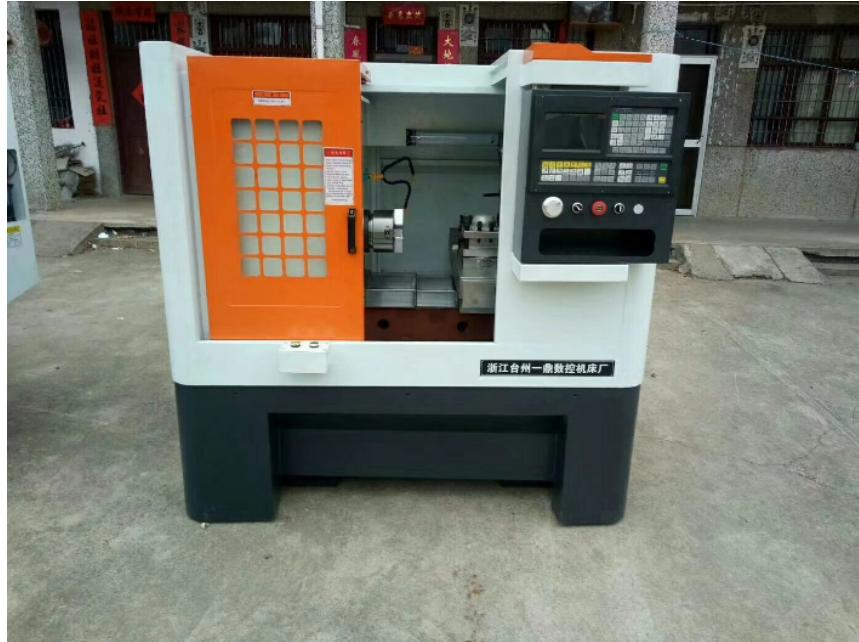
线轨机床工作中须经常从透明油标中察看输往主轴承及床头箱的油是否畅通。工作前须束紧服装、套袖、戴好工作帽，工作时应检查各手柄位置的正确性，应使变换手柄保持在定位位置上，严禁戴围巾、手套操作。不许在卡盘上，导轨上面敲打校直和修正工作。用卡盘卡工件及部件时，须将扳手取下，方可开车。不许将加工工件工具或其它金属物品放在床身导轨上。在工作中严禁开车测量工件尺寸，如要测量工件时，须将车停稳，否则会发生人身事故和量具损坏。装卸花盘、卡盘和加工重大工件时，须在床身面垫上一寸板，以免落下损坏机床。
