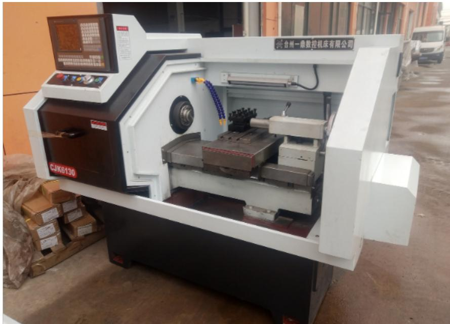
斜线轨数控机床主轴一体化的结构，并经过动平衡校正，因此具有良好的回转精度和稳定性。纵横向导采用高精度直线导轨副，定位精度高，动态性能好，快速移动速度可达17m/min。线轨机床制造商作为汽车零部件加工线的主机供应商，不仅要重视主机的设计制造，还要高度重视构成现代敏捷柔性单元的各要素的开发，如机械手，输送装置等。因为线轨机床装置的可靠性影响了生产线的开动率。而开动率对于大规模生产的汽车制造业工业是非常重要的。线轨机床执行装置一系列问题，线轨机床执行装置用于连接工作部件，将工件介质的压力能转换为工件部件的机械能，常见的有进行直线运动的动力缸（包括液压缸和气缸）和进行回转运动的液压马达、气马达。云南高速数控线轨机床线轨机床导轨采用中频淬火磨削和贴塑工艺，具有良好的耐磨性和精度保持性。
